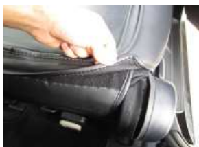
10、6で引き出したカバーをマジック テープで固定します。
