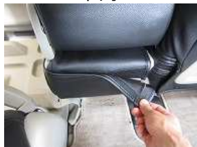
3、2で入れ込んだカバーを後ろから引き出し、マジックテープで固定します。
