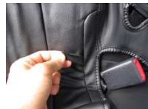
4、1で外したシートベルトのバック ル固定用のバンドを、カバーの穴 から取り出します。
