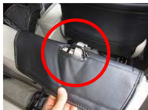
3、座面を起こし、赤丸部のバンドと フックをカバーの穴から取り出しま す。
