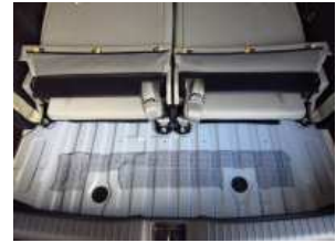
4、プラスチックのパーツを取り外します。 背もたれにカバーを取り付けた後に元に戻します。
