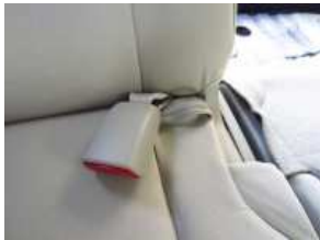
5、シートベルトのバックルを固定しているバンドを外します。
