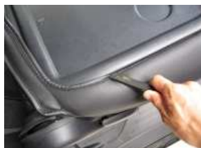
11、シート背面のボード部分に、付 属のヘラを使用してカバーを入れ 込みます。
