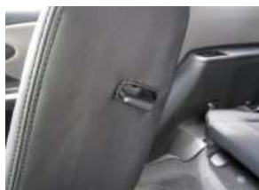
9、シート側面のフックとカバーの穴 位置を正確に合わせます。
