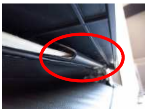
5、4で引き出したカバーについているフックをシートに直接引っ掛け固定します。
