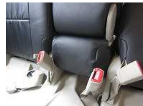
4、カバーの穴からバンドを取り出し、バックルを固定し完成です。
