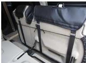
6、カバー側面の紐をシート裏側で 結び固定します。
