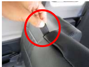
3、アームレスト先端バンドを、赤丸部のカバーの穴から引き出します。
