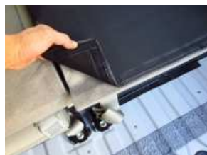
7、背もたれ裏側のカバーはマジックテープで直接シートに固定します。
