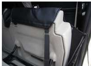
5、カバー前方のバンドを後ろへ回 し、赤丸部の金具を通し固定しま す。
