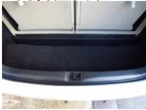
1、ラゲッジ部のボードを取り出します。
