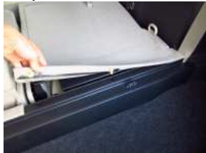
2、丸部の純正生地を固定しているピンを内張りはがしで外します。
