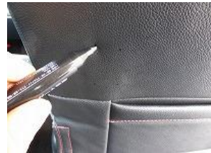
12、コンビニフックの角にマジックで印を付けます。その際、1cm程内側に印を付けます。
