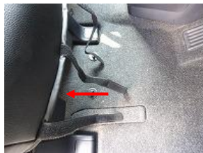
11、前方のバンドも後方と同じようにシート裏側で固定します。 ※シートの可動の妨げにならない箇所を通して下さい。
