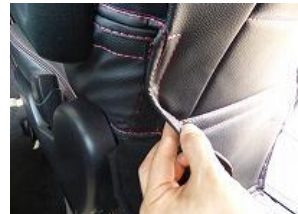
8、7の固定後に後方部のマジックテープとも張り合わせ固定します。
