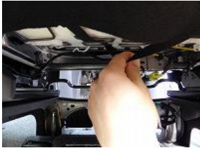
1、シート裏側に引っ掛けてある純正のゴムを外します。
