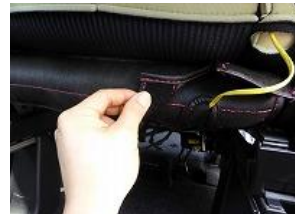
6、5で引き出したカバーの裏側のマジックテープを座面カバーのマジックテープと張り合わせ固定します。
