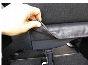
6、5で引き出したカバーの裏側のマジックテープをシートに直接張り付け固定します。
