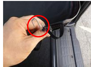
10、9で張り付けたカバーの先端に付いているゴムにS字フックを取り付け、シート裏側の金属部分に引っ掛け固定します。
