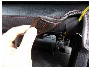
7、6で引き出したカバーの裏側のマジックテープをシートに直接張り付け固定します。
