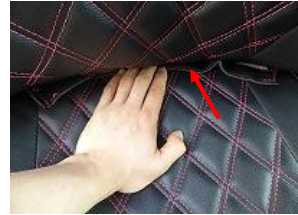
4、座面との間にカバーを入れ込みます。
