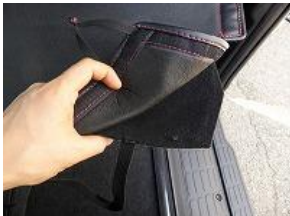
9、後方カバーのマジックテープを純正生地に直接張り付けます。
