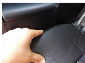
7、右側面のカバーを隙間に差し込みカバー裏側のマジックテープをシートに直接張り付け固定します。
