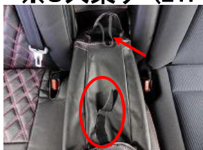
10、カバー裏側で赤丸のバンドを矢印のゴムに通し、マジックテープで固定します。その際、強く引っ張り過ぎるとトレイが戻しにくくなります。
