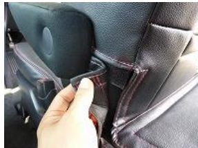
7、3で逃がしておいたカバーをマジックテープで固定します。
