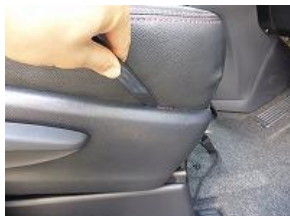
10、側面のカバーをプラスチックの隙間にヘラを使い入れ込みます。
