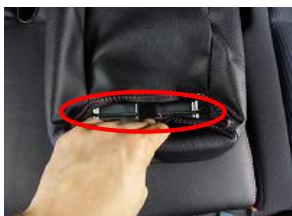
13、トレイを戻す際は赤丸の金属部分にトレイの引っ掛け部分を外した時と逆方向に差し込むように戻します。
