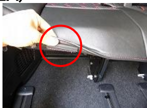
2、赤丸の前方のブラフックをシート本体の裏側に引っ掛け固定します。
