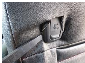
15、付属のヘラを使い、生地を差し込んでいきます。※差し込むには力があるため、ゴム手袋などを使用しますと差し込みやすくなります。
