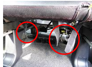
8、6で引き出したカバーに付いている赤丸のバンドをシート裏側の金属部で折り返し、マジックテープで固定します。
