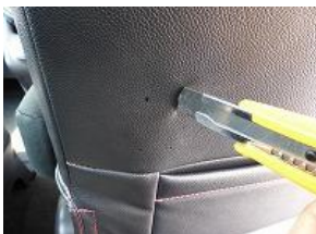
13、12で付けた印に合わせてカッターで切れ目を入れていきます。
