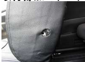
2、カッターやはさみで切れ込みを入れます。 ※大きく開け過ぎないように少しずつ穴を拡大して下さい。
