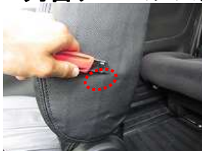
1、背もたれにカバーを正確に被せた後、アームレスト取付の穴位置にマジック等で印を入れます。
