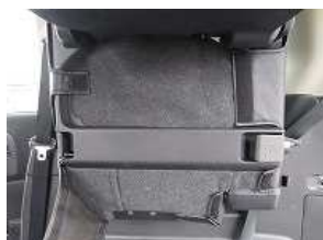
5、シートを跳ね上げ、4で入れ込んだカバーを引き出します。
