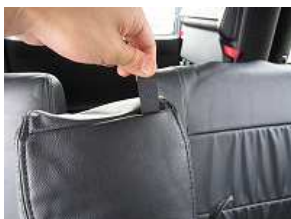
3、背もたれのリクライニング調整用のベルトを穴より取り出します。
