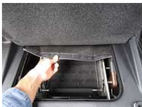
5、シート下のボックスを取り外し、3で入れ込んだカバーをシート下より引き出します。
