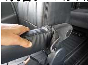
1、背もたれに本体を取り付けた後、アームレストにカバーに取り付けます。
