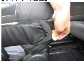
2、ラインを合わせながら、根元のゴムの線が見えない様に、奥までカバーを被せて下さい。
