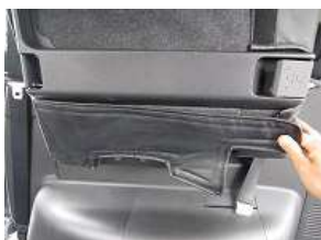
6、前方のカバーを後ろへ回し、マジックテープで固定します。
