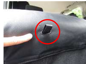
4、跳ね上げ用のベルトをカバーの穴より取り出し、シートを跳ね上げます。
