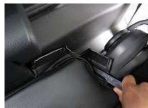
4、リクライニングレバー部のカバーを隙間に入れ込みます。
