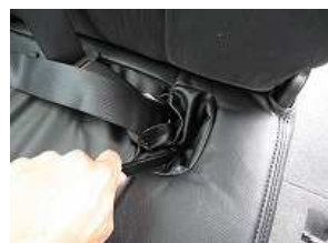
8、シートをも戻し、シートベルトバックル部のカバーを折り返し入れ込みます。
