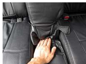
4、座面との隙間からカバーを入れ込みます。
