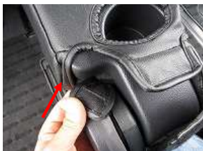
7、側面は直接シートにマジックテープで固定します。
