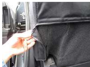
7、外側のカバーのマジックテープをシートに直接固定します。
