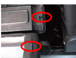
6、テーブルの前方のツメは、赤丸部の位置で固定してあります。
