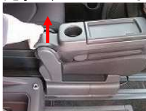
2、テーブル本体の後方を矢印の向きに引っ張ります。 (テーブルは3箇所ツメで固定してあります)
