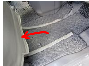
8、カバー前方のバンドをシート下を通して後ろに回し固定します。 ※シート下を通す際は、シートの可動の妨げにならない箇所を通して下さい。
