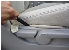
5、付属のヘラを使用して、側面のカバーをプラスチック部へ入れ込みます。
