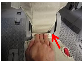
9、背もたれの付け根の下からカバーを入れ込みます。
