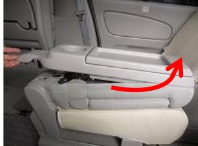
2、後方が外れたら矢印の方向に持ち上げテーブルを取り外します。
