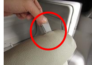
4、背たれ上部のバンドを赤丸部のカバーの切れ込みから引き出します。
