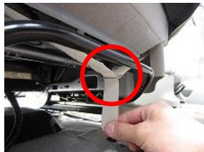
7、6で入れ込んだバンドをシート下で、赤丸部の金具を通してマジックテープで固定します。
