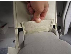
7、アームレストを倒し、奥から6で入れたんだカバーを引き出します。
