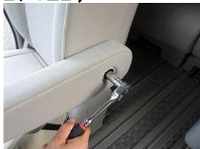
2、ボックスレンチを使用し、中のボルトを外し、アームレストを取り外します。 (ボルトサイズ 14mm)
