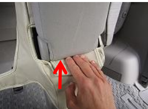
6、アームレストの付け根の下からカバーを入れ込みます。
