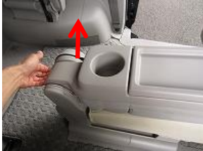
1、テーブル本体の後方を矢印の向きに引き上げます。
