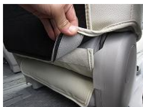
7、6で引き出したカバーのマジックテープを背面部と固定します。
