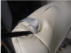
9、ヘラを使用し、肩口のベルトの台座の下にカバーを入れ込みます。
