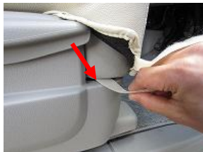
6、カバー側面のバンドを矢印の箇所に入れ込みます。 (内側面も同様の箇所から入れ込んで下さい。)
