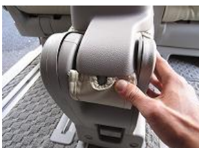
13、10で引き出したカバーをプラスチック部の中に入れ込みます。
