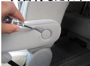
1、アームレスト側面のカバーを内張りはがし等で外します。
