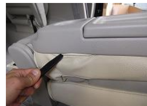
12、テーブルを取り付け、ヘラを使用して、側面のプラスチック部分へカバーを入れ込みます。
