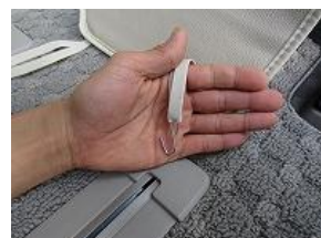
8、カバーの先端のバンドに付属のS字フックを取り付けます。
