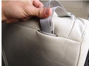
10、カバーの切れ込みから、ベルトを純正の収納部に入れ込みます。
