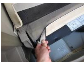
6、5で引き出したカバーの魔术テープを直接シートに固定します。
