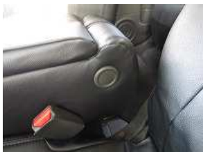
14、側面のカバーを取り付け完成です。
