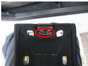
9、赤丸部のネジをプラスドライバーで外し、ロック部を取り外します。
