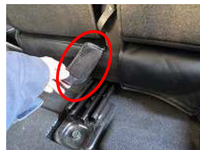
4、3で引き出したカバーをシートに直接マジックテープで固定します。
