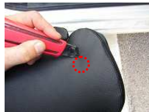
12、背もたれに固定するボルトを通す穴をカッター等で開けます。予め印を入れ、小さく穴を開け徐々に大きくして下さい。
