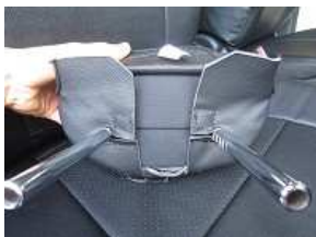
3、ヘッドレストのシャフトと生地のア位置を合わせ、マジックテープで固定します。
