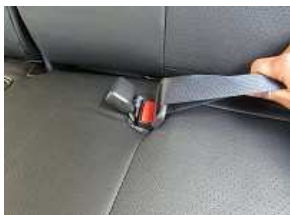
10、座面を車輦に戻し、バックルを取り出す際は、画像の様にベルトを固定し引っ張りだすと取り出しやすくなります。
