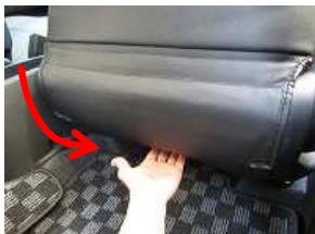
9、バックポケット下部のカバーをシート下に巻き込みます。
