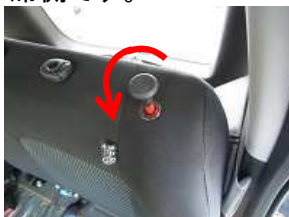
3、背もたれを倒すノブを反時計回りにまわし外します。
