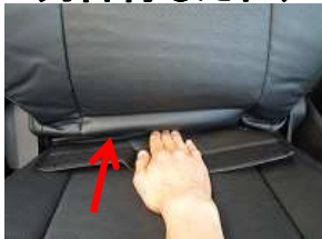
5、座面との隙間にカバーを入れ込みます。
