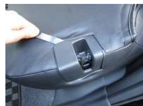
11、リクライニングロック部回りのプラスチック部の内側にカバーを入れ込みます。
