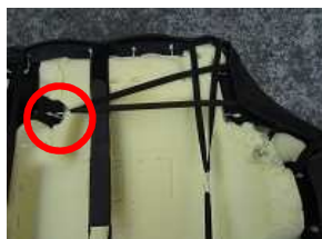
7、カバー側面の短いバンドはシートの金属部に引っ掛け固定します。
