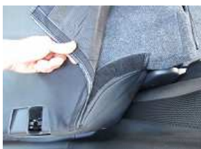
10、カバー側面のマジックテープを固定します。
