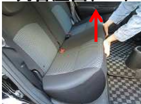
1、座面の手前側を真上に持ち上げ、フックの固定を外します。
