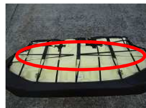
8、カバー側面の長いバンド同士をS字フックで固定します。
