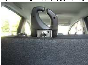
2、中のナットをソケットレンチを使用し外し、ガイドを取り外します。 (※ナットサイズ 14mm)
