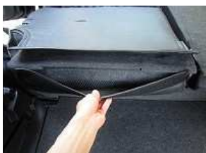
9、背もたれを倒し、7で入れ込んだカバーを後ろから引き出します。
