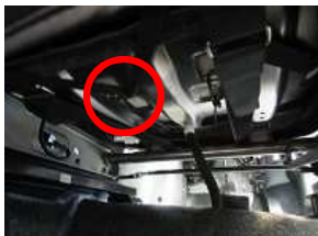
10、8で取り付けしたS字フックをシート下の金属部に引っ掛け固定します。
