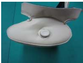
6、後席センターヘッドレストも同様 に取り付け、可動のボタン部の生 地を台座の下側に入れ込みます。
