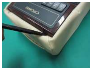
11、6で取り外したカバーを取り付 け、付属のヘラで生地をカバーの 隙間に入れ込みます。
