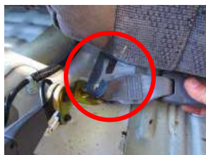
3、丸部のフックからシートベルトを外しておきます。
