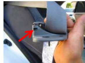
8、シートからガイドを取り外した後、矢印の箇所のツメを解除しシートベルトを外します。
