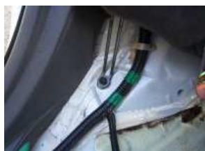
5、シートを固定しているボルトを外します。 ※左右2箇所 (ボルトサイズ 12mm)
