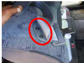
7、肩口のシートベルトのガイド部のネジを緩め取り外します。
