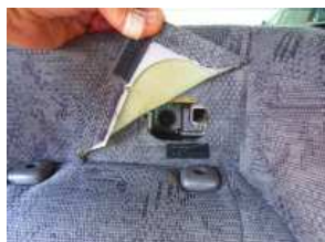
1、センターヘッドレスト奥の純正生地をめくり、中のボルトをソケットレンチで外します。 ※左右2箇所 (ボルトサイズ 12mm)
