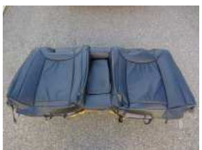
10、カバーを全体に被せ、シートとカバーのラインを合わせます。
