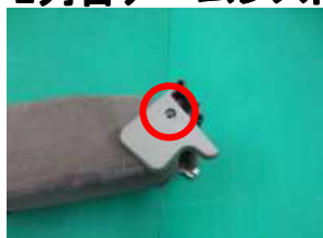
1、赤丸部のナットを外し、プラスチックカバーを取り外します。 (ナットサイズ7mm)
