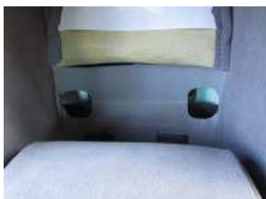
2、アームレスト奥の純正生地をめくり、中のボルトを外します。 ※左右2箇所 (ボルトサイズ 12mm)
