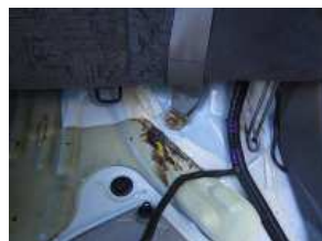
4、シートベルトを固定しているボルトを外します。 ※左右2箇所 (ボルトサイズ 14mm)
