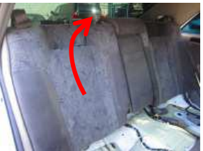
6、背もたれ下部を持ち、上に押し上げロックを解除したのち、手前に引きシートを車外に取り出します。
