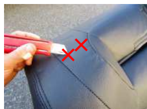
12、7で取り外したガイドのネジを通す切れ込みをカッターで入れます。
