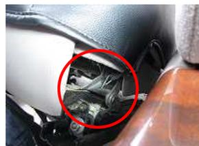
8、6で取り付けしたS字フックをシート下の赤丸の金属部に引っ掛けます。
