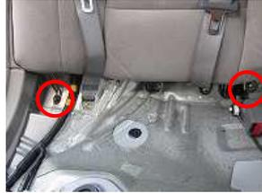
3、背もたれ下部を固定しているボルトを緩め外します。
