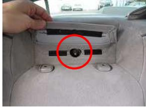
2、ヘッドレストを取り外し純正の生地をめくり中のナットを緩め外します。
