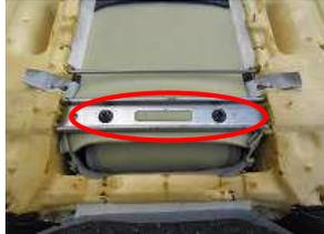
6、裏側のアームレストを固定しているナットを外します。
