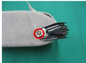
3、赤丸部のネジを外し、金具を取り外します。
