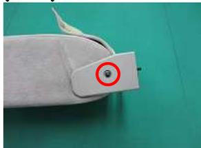
2、赤丸部のナットを外し、プラスチックカバーを取り外します。
