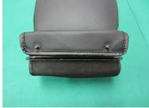
10、カバーに穴を開けボルトを取り出します。
