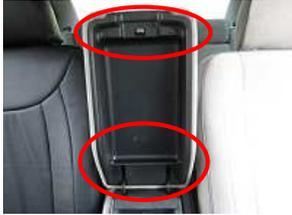
1、フタの内側のカバーを取り外します。プラスドライバーで赤丸部のネジを外します。(9箇所)
