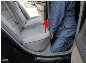
1、シートの前方(手前)を上を持ち上げてピンの固定を解除します。
