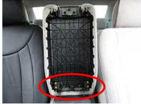
2、カバーを取り外した後、赤丸部のネジを緩めオープナーを外します。
