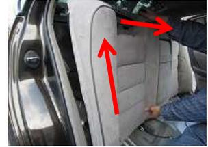
4、シート本体を上を持ち上げ、手前に倒し車両より取り外します。
