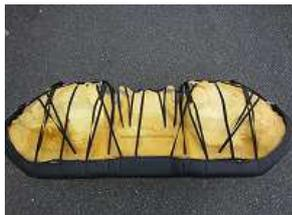
6、その他のバンドは先端にS字フックを取り付け、シートの金属部に引っ掛け固定します。
