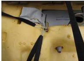
10、裏側のバンドは先端にS字フックを取り付け、画像のようにシートの金属部に引っ掛けます。
