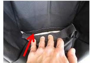
12、アームレストの下部は、カバーを隙間に入れ込み裏より引き出します。
