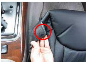
6、内側側面の赤丸部のバンドに付属のS字フックを取り付けます。
