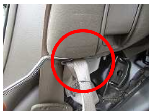
1、シートベルトを固定しているガイドを取り外します。
