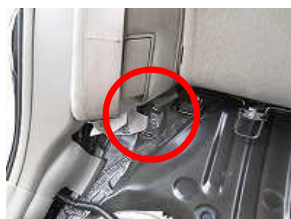
2、シートベルトを固定しているボルトを取り外します。 (ボルトサイズ 14mm) ※画像は運転席側
