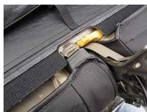
11、内側のプラフックはシートに直接引っ掛け固定します。
