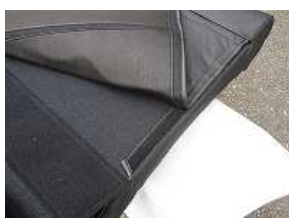
10、シート裏面のマジックテープを固定します。
