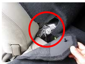
4、背もたれを倒し、純正の生地をめくり、中のボルトを取り外します。 (ボルトサイズ 12mm) ※画像は運転席側
