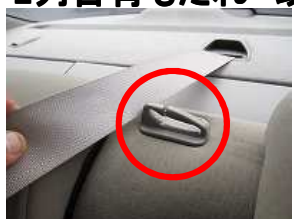
1、センターのシートベルトをガイドより取り外し、ガイドのネジをプラスドライバーで緩め、取り外します。
