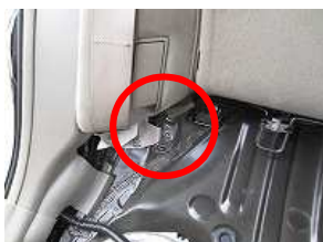
2、シートベルトを固定しているボルトを取り外します。 (ボルトサイズ 14mm)
