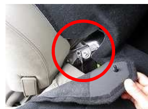
4、背もたれを倒し、純正の生地をめくり、中のボルトを取り外します。 (ボルトサイズ 12mm)
