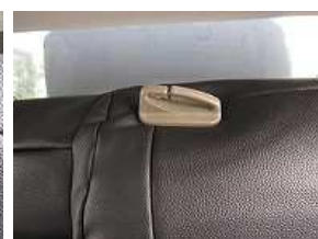
12、ガイドを取り付けます。 背もたれとヘッドレストが一体型も同様に取り付けを行って下さい。
