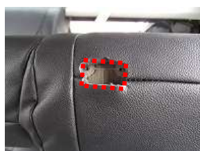
11、1で取り外したガイドを通す穴を開けます。 カッターで切れ込みを入れ、徐々に大きく穴を開けて下さい。
