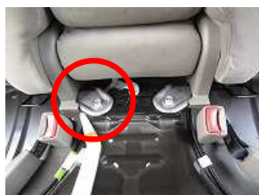
3、シートベルトバックル奥のボルトを取り外します。 (ボルトサイズ 12mm)
