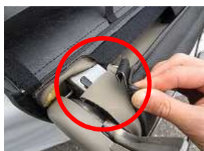
9、角のプラフックはシートに直接引っ掛け固定します。
