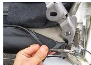
8、7で入れ込んだカバーのマジックテープを直接シートに固定します。
