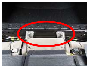
2、アームレストの奥のボルトを取り外します。 (ボルトサイズ 12mm)
