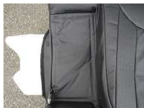
7、アームレストの収納部のラインを合わせ、マジックテープを直接シートに固定します。
