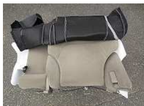
5、車外にシートを取り出し、カバーを裏返し上から被せ、シートとカバーのラインを合わせながら全体に被せます。
