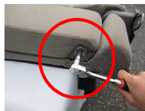
4、中のボルトを緩め外し、アームレストを取り外します。 (ボルトサイズ 12mm)
