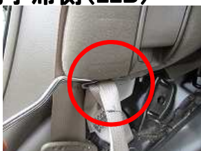
1、シートベルトを固定しているガイドを取り外します。 ※画像は運転席側
