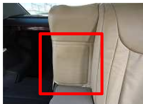
5、アームレストの収納部のカバーのマジックテープをシートに直接貼りつけ固定します。
