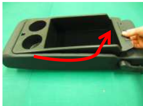
2、小物入れを矢印の方向に持ち上げ、取り外します。
