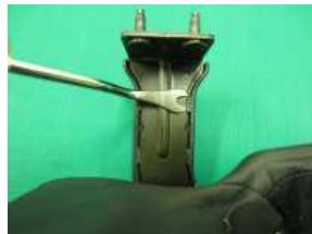
3、内張りをはしを使用し、側面の留め具のプラスチックカバーを外します。
