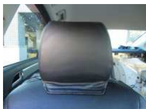
1、カバーを裏返しラインを整えながら半分ほど被せます。 ※背もたれより取り外さずに作業を行うとスムーズに取付け出来ます。
