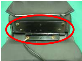
1、赤丸のネジを外し、フタと蝶つがいを取り外します。
