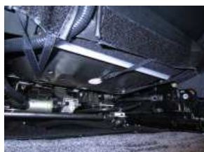
7、6で取り付けしたS字フックをシート下の金属部に引っ掛け固定します。
