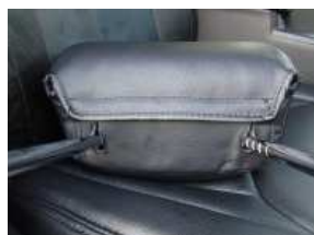
3、ヘッドレストのシャフトとカバーの穴位置を合わせ、マジックテープで固定します。
