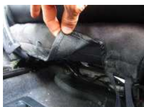
5、座面のマジックテープと4で引き出したカバーのマジックテープを固定します。
