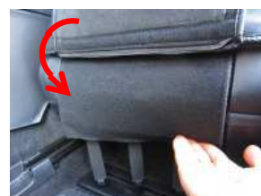
7、座面-1で外した純正の生地を元に戻し、上からカバーを被せマジックテープで固定します。
