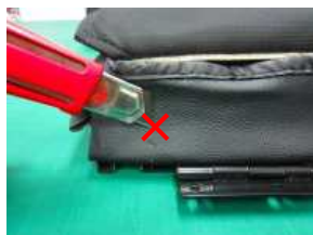
17、蝶つがいのネジを通す切れ込みをカッターで入れます。
