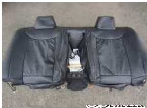
9、カバーを全体に被せ、シートとカバーのラインを合わせます。
