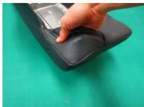
6、アームレストの付け根の箇所は生地の伸びを利用し、しっかりとカバーを被せて下さい。
