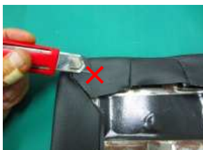
14、10で外したネジを通す切れ込みをカッターで入れます。
