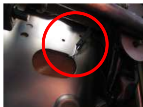
11、10で取り付けしたS字フックはオットマン裏側の金属部に引っ掛け固定します。
