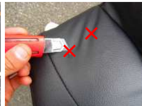
11、8で取り外したガイドのネジを通す切れ込みをカッターで入れます。
