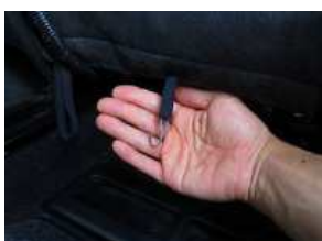
6、カバー先端のゴムバンドにS字フックを取り付け、座面と同様にシート下の金属部に引っ掛け固定します。
