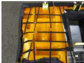
10、シートを裏返し、向かい合うゴムバンド通しをS字フックで固定します。
