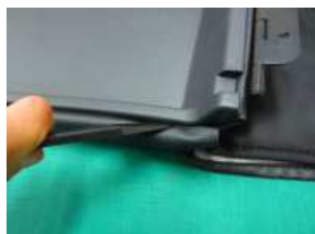
16、プラスチックパーツの周りのカバーをヘラを使用し入れ込みます。
