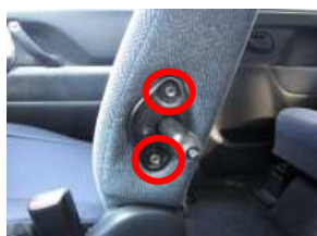
3、アームレストの台座部をソケットレンチを使用し、取り外します。 (ボルトサイズ10mm)
