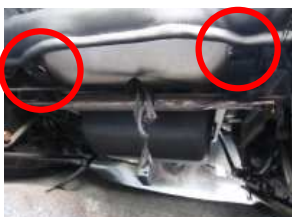
10、赤丸部の部分に9で後ろに回したバンドを通し、マジックテープで固定します。 ※バンドを引っ張り過ぎると切れますので注意して下さい。
