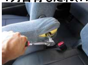
1、アームレストを取り外します。純正生地のチャックを開き、ソケットレンチを使用し、中のネジを外し、レバーを取り外します。 (ボルトサイズ12mm)
