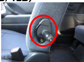
2、アームレストの軸についているプラスチックカバーを取り外します。
