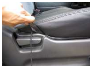
5、付属のヘラを使用して、側面のプラスチックの部分にカバーを入れ込みます。
