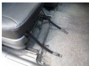
9、カバー前方のバンドをシート下を通して後ろに回し固定します。
