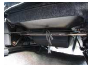
8、7で引き出した紐をシート下で、固定します。 ※シート可動の妨げにならないように注意して下さい。
