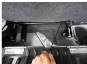
7、カバー側面についている紐をシート後ろから引き出し、シート下で固定します。
