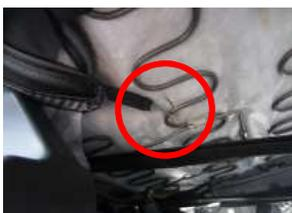
9、8で取り付けしたS字フックをシート下へ固定します。
