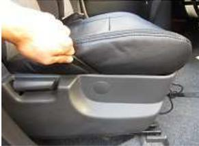
5、側面のカバーを付属のヘラでプラスチック部の内側に入れ込みます。
