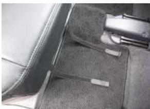
5、カバー後方のバンドをシート下を通して前に回し固定します。
