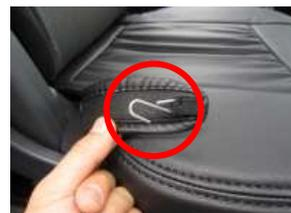
8、シート側面のゴムバンドの先端に付属のS字フックを取り付けます。
