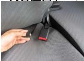
1、まず初めに、シートベルトのバックルを固定しているバンドを外します。
