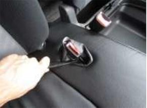
9、ヘラを使用して、シートベルトバックル部にカバーを入れ込みます。
