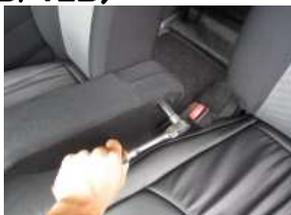
2、ソケットレンチを使用し、中のネジを外します。(ナットサイズ12mm)
