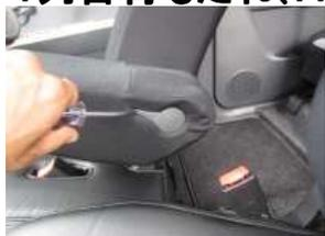
1、アームレストを取り外します。内張り剥がし等でフタを外します。
