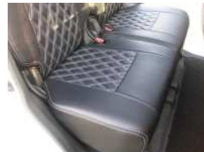
4、シートベルトバックル部の生地を運転席と同じ様に折り返し完成です。助手席側も同様に取付けます。
