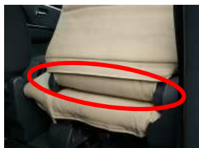
7、座面と背もたれの間から引き出した生地についているマジックテープと、背もたれ裏側のマジックテープを固定します。
