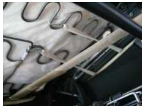
3、側面から出ているゴムバンドを、S字フックを使用し車体側に固定します。(シートの可動の妨げにならないように固定して下さい)
