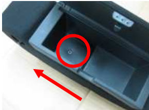
2、小物入れがある場合、小物入れを取り外します。赤丸のネジを外し矢印方向にスライドさせながら小物入れを取り外します。
