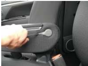
2、側面のカバーを先の細いマイナーストライパーや内張り剥がしで外します。
