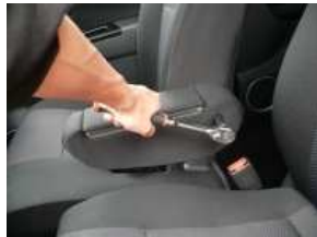
3、アームレストを固定しているボルトをソケットレンチで取り外します。(ボックスサイズ: 12mm)
