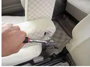
2、ボックスレンチを使用し、中のネジを外し、アームレストを取り外します。(ボルトサイズ 12mm)
