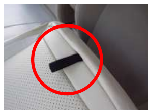
15、赤丸部のバンドをカバーの穴から引き出します。
