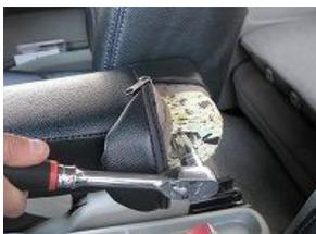
5、ソケットレンチ(12mm)を使用して、シートにアームレストを取り付けます。
