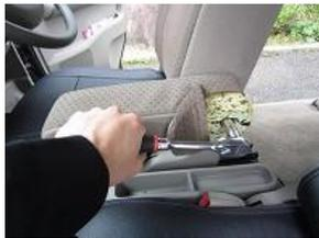
2、本体側面の純正生地をめくり、ソケットレンチを使用しボルトを緩めアームレストを取り外します。(ボルトサイズ12mm)
