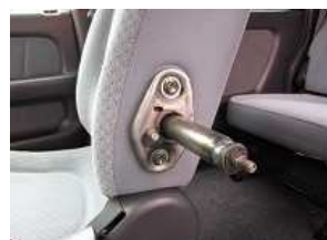
4、台座を固定しているボルトをボッ クスレンチで取り外します。 ※ボルトサイズ 12mm
