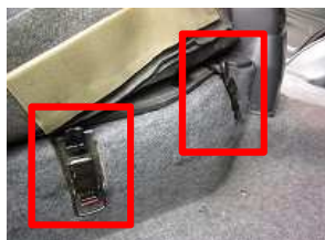
5、シート前方の生地をめくり、四角部のロックを解除します。
