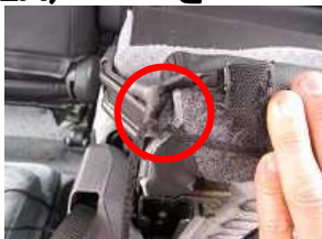
10、外側面の紐を内側面の丸部の輪を通して。
