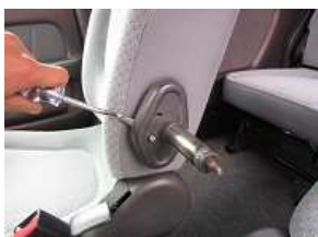
3、台座のカバーを内張りはがし等 を使用し取り外します。
