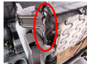
12、内側面の紐も10の輪に通し結び固定します。
