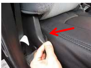
10、カバー側面の紐を矢印の箇所から通します。
