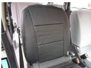
7、表に返しながらシートとカバーの ラインを合わせ左右均等に下ろし ます。
