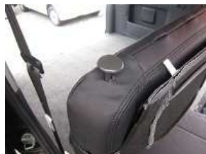
3、1で外したノブを取り付けます。
