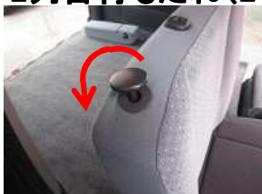
1、リクライニングのノブを反時計回りに回し取り外します。
