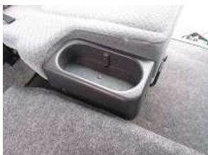
14、助手席側は小物入れのネジを緩め取り外します。 (※計3箇所)
