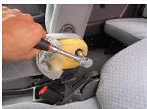
2、中のナットをボックスレンチを使 用し緩め取り外します。 ※ナットサイズ 12mm
