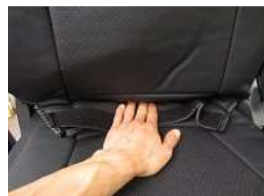
8、座面との隙間にカバーを入れ込 みます。カバーの端は付属のヘラ を使用し入れ込んで下さい。
