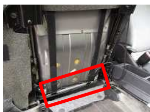
9、シート下を通したバンドは4で引き出したカバー先端の金具を通し、固定します。
