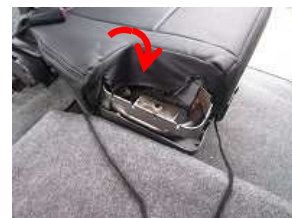
16、カバーを被せ小物入れ周辺の生地マジックテープをシートに直接固定します。
