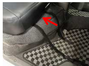
8、シートを下ろし、カバー前方のバンドをシート下を通して後ろに回します。
