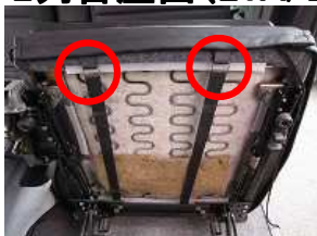
9、シートを跳ね上げカバー前方のバンドを丸部の赤丸部の金具を通してマジックテープで固定します。
