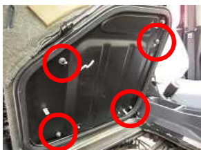
7、鉄板を固定しているナットを、ソケットレンチを使用し外します。 (ナットサイズ 12mm×4箇所)
