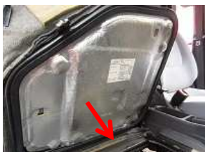
6、シートを跳ね上げ、中のアルミシートを取り外します。
