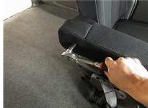
11、ボックスレンチを使用し、中のボルトを外し、アームレストを取り外します。
