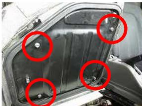
7、鉄板を固定しているナットを、ソケットレンチを使用し外します。
