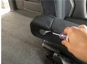
10、助手席側はアームレストを外します。本体側面のカバーを内張りをはがして取り外します。
