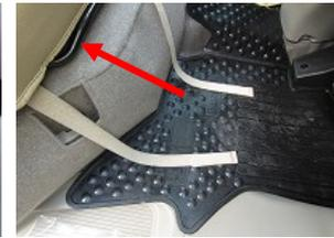
8、カバー前方のバンドをシート下を通して後ろに回します。
