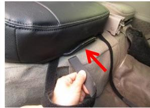
8、カバー前方のバンドをシート下を通して後ろに回します。
