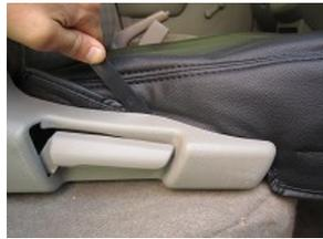
7、付属のヘラを使用し、プラスチック部の内側にカバーを入れ込み、再度ネジを取り付けます。
