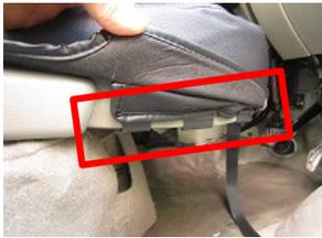
5、カバー側面のフックをシートに直接引っ掛け固定します。
