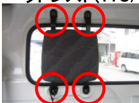
1、赤丸部のネジをドライバー外し、ヘッドレストを取り外します。(4箇所)
