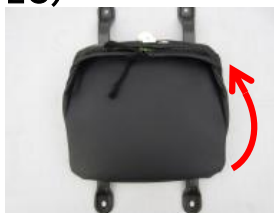
2、ヘッドレストの下側よりカバーを被せます。
