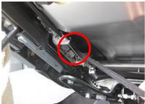
9、側面のゴムバンドはシートレールとシートの隙間(赤丸部)から内側に入れ込んでさせませ。※633品番はブラフックをシート本体に引っ掛けて固定させませ。
