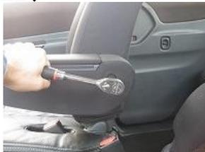
2、ソケットレンチを使用してアームレストを取り外します。(ボルトサイズ12mm)
