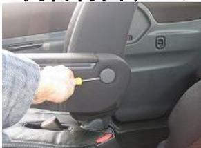
1、アームレストを外します。側面のカバーをマイナスドライバー等で外します。
