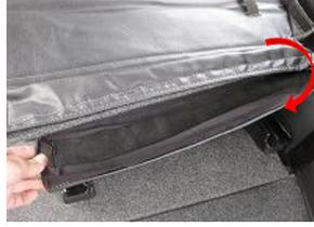
7、ボード部も直接マジックテープを貼りつけ、折り返して裏面にも貼り付けます。
