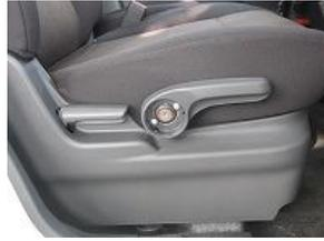
2、中のネジを外し、レバーを取り外します。
