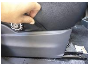
10、付属のヘラを使用し、プラスチック部の内側にカバーを入れ込みます。
