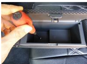
1、始めに小物入れ内部のネジを外します。
