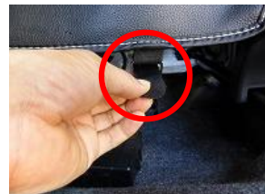
8、7で回したバンドを後方の金属リングに通し、マジックテープで固定します。
