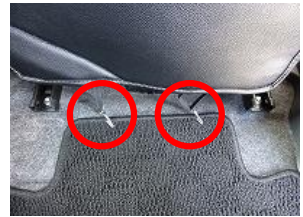
8、カバー後方のゴムにS字フックを取り付け、シート裏に引っ掛け固定します。
