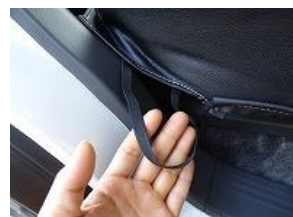
8、外側側面のゴムをシート裏の金属部に引っ掛け固定します。
