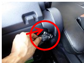
7、シート下側の赤丸の部分を矢印の方向へ入れ込みます。
