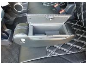
5、取り外した時と逆の手順で小物入れを戻します。
