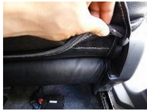
7、6で引き出したカバーのマジックテープを張り合わせ固定します。
