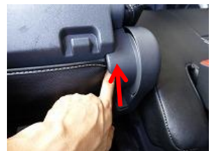
8、7で入れ込んだ部分を奥の空洞部分まで指でさらに押し込み固定します。
