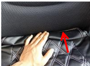
5、背もたれとの隙間にカバーを入れ込みます。
