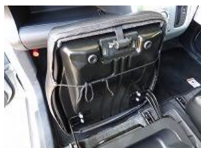
3、両側のヒモをシート裏で結び固定します。※ヒモの結び方はP4参照
