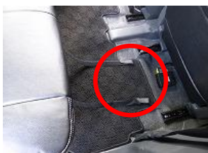
5、カバー前方のバンドをシート下を通して後ろに回します。その際、スライドのレバーの上側を通してください。
