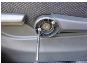
2、中のネジはプラスドライバーを使用し緩め、レバーを取り外します。
