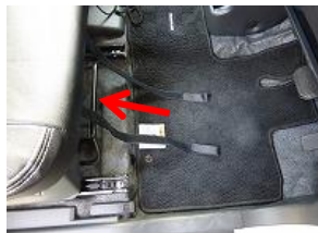
7、カバー前方のバンドをシート下を通して後ろに回します。その際、スライドレバーの上側を通してください。
