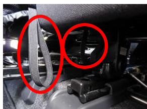
11、内側の2本のゴムも同様にシート裏の金属に引っ掛け固定します。
