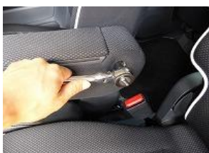
2、ソケットレンチを使用し、中のボルトを緩め、アームレストを取り外します。 (ボルトサイズ 12mm)
