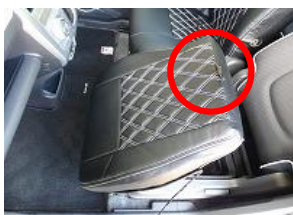
2、シートを跳ね上げ、表に返しながらシートとカバーのラインを合わせます。その際、赤丸のバンドは取り出しておきます。
