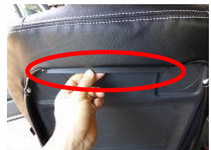
4、赤丸のプラスチック部分をテーブルの内側に差し込みます。
