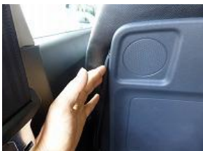
5、テーブル側面の生地も指で入れ込み、最後にヘラで押し込みます。
