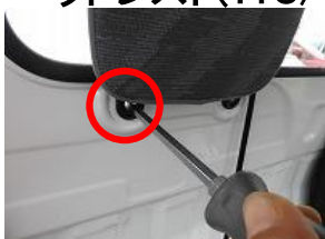
1、赤丸部のネジをプラスドライバーで外し、ヘッドレストを取り外します。(4箇所)
