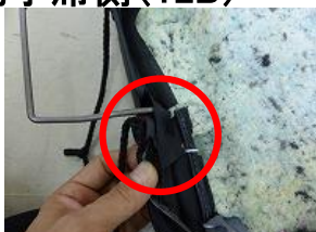
2、赤丸部のマジックテープを金属バーを避けるようにして張り合わせ固定します。
