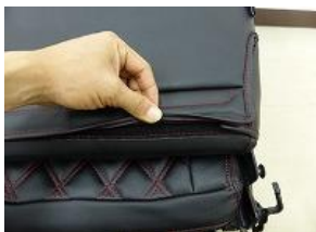
6、4で引き出したカバーのマジックテープを張り合わせ固定します。
