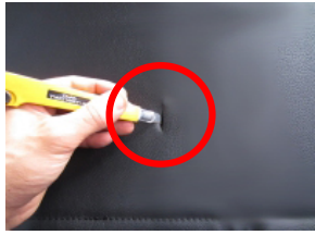
6、1で外したバンドの台座部を固定する為に、カバーに切れ込みを入れます。
