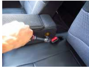
3、中のボルトをソケットレンチで緩め、アームレストを外します。(14mm)
