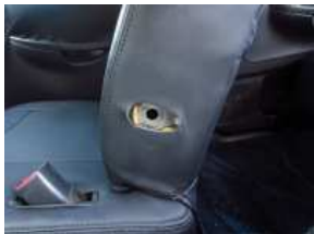
2、加工を施した画像 ※大きく開け過ぎないように少しずつ穴を拡大して下さい。
