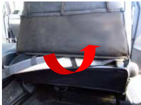
9、座面作業時に取り外した純正の生地を、カバーの内側に入れ込みます。
