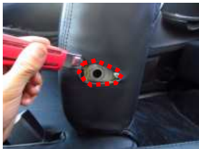
1、背もたれのカバーを正確に被せた後、アームレスト取付の穴位置にマジック等で印を入れ、カッターやはさみで切れ込みを入れます。
