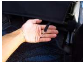
10、背面のカバーの先に付いているバンドに、付属のS字フックを取り付け、シート下の金属部に引っ掛け固定します。
