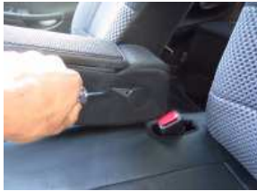
1、アームレスト側面のキャップを内張り外し等で取り外します。
