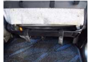
7、6で入れ込んだカバー先端のバンドを後ろから引き出します。
