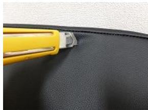
7、1で取り外した部分のネジ穴位置にカッターで切れ込みを入れます。
