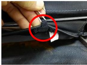
6、後方のゴムにS字フックを取り付け、カバー先端のゴムにそれを通してします。
