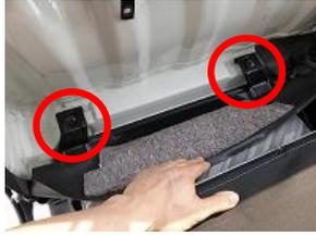
2、シートを前にスライドさせ、後方の丸部のボルトを緩め、シートを取り外します。
