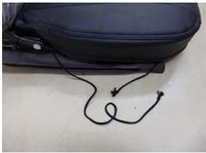
5、前方の紐もサイドに回し双方の紐を結び固定します。
