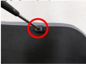
1、背面裏側の赤丸の部分をプラスドライバーを使い取り外します。
