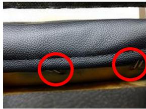
7、6のS字フックをシート裏の金属部分の穴に引っ掛け固定します。
