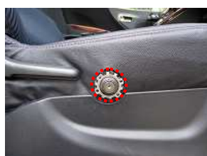
11、シートリフターの軸の箇所を通す穴を開けます。
