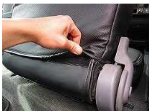
7、6で入れ込んだカバーのマジックテープを固定します。
