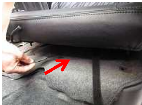
6、シート前方を浮かせ、カバーに付いているマジックテープバンドをシート下を通して後ろへ回します。
