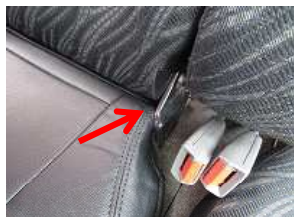
9、内側面は画像の矢印の箇所を通して後ろへ回します。
