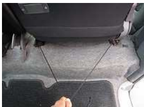
10、各々後ろへ回した紐をシート下で結び固定します。
