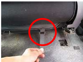
7、6で後ろに回したバンドを赤丸部の金具を通してマジックテープで固定します。
