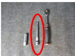
2、アームレストの幅が広いので、既存のソケットではボルトに届きません。画像のような10cm以上の延長アダプターを使用して下さい。
