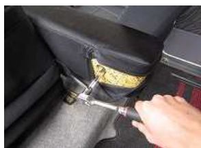
1、アームレストのチャックを開き、ソケットレンチでボルトを緩め取り外します。 (※ボルトサイズ 14mm)
