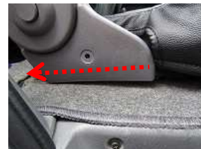
8、側面の紐をプラスチックカバーの内側を通して後ろへ回します。
