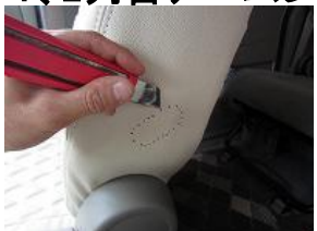
1、背もたれの生地を正確に被せた後、アームレスト取付の穴位置にマジック等で印を入れます。
