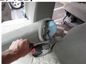
2、アームレストを固定しているボルトを外し、アームレスト本体を取り外します。
