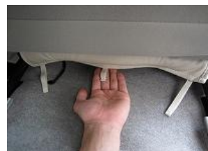
16、3で引き出したカバーのバンドも同様に先端にS字フックを取り付けシート下で固定します。
