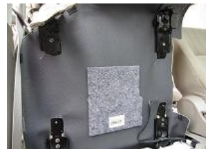
12、防音シート・鉄板を取り外した画像
