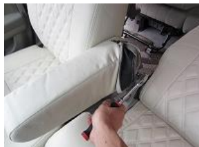
3、取り外した反対の手順で背もたれに取り付けます。
