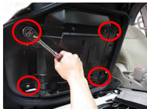
11、鉄板を固定しているネジを外します。(4箇所) (ナットサイズ10mm)
