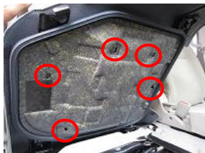
10、シートを跳ね上げ裏の赤丸に示すロック部を起こし、防音シートを外します。
