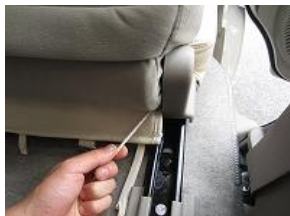
6、5で入れ込んだ紐を後ろから引き出します。
