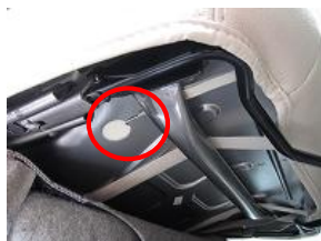
15、カバー前方のゴムバンドの先端にS字フックを取り付けシート下の金属部に引っ掛け固定します。
