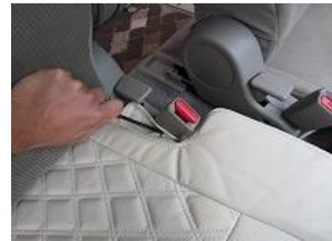
4、シートベルトバックル周辺は、ヘラを使ってカバーを入れ込みます。
