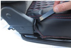
9、付属のヘラを使用しプラスチック部の内側にカバーを入れ込みます。
