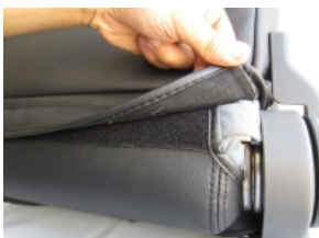
5、4で引き出したカバーのマジックテープを固定します。
