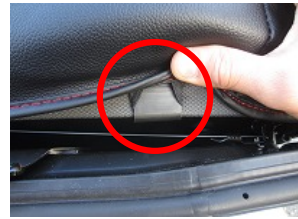
8、3のフックはシートに直接引っ掛け固定します。
