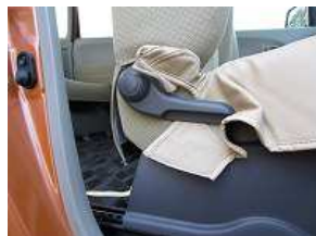
7、レバー部はレバー本体を逃しながらカバーを被せます。
