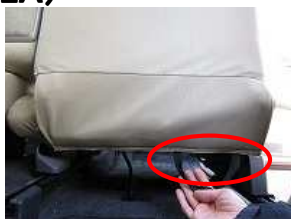
2、シート下にゴムバンドで固定してありますので、外します。
