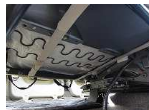
12、シート下を通した画像です。シートの可動の妨げにならないように通してください。
