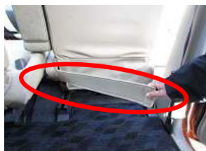
17、手に持っているカバーは背もたれを取り付けした後に固定します。
