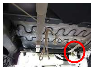
14、反対側の紐は赤丸部(シートの角)を通した後、シート下にて13で作った輪の中を通し固定します。
