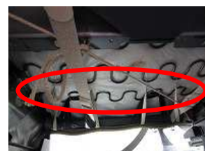
16、シート下の金属部にS字フックを固定します。
