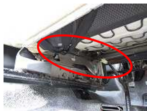
3、内側は配線が通ってますので、カプラー(接続部)を外し、バンドを外します。
