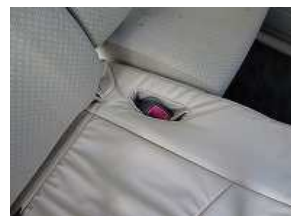
18、シートベルトのバックル部のカバーを中に折り返します。
