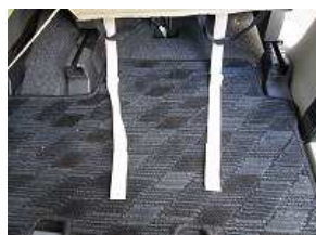
11、6で引き出したカバーの先端のマジックテープを、シート下を通し前へ回し固定します。
