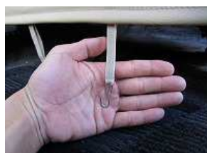
15、6で引き出したカバーの先端のゴムバンドにS字フックを取り付けます。
