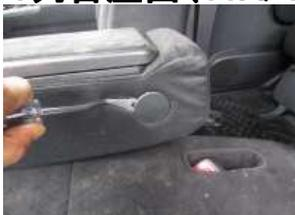
1、はじめにアームレストを取り外します。側面のカバーを内張りはがし等で外します。
