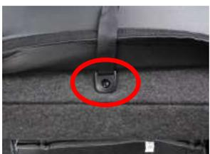
5、シート背面にあるバンドのネジをプラスドライバーで取り外します。
