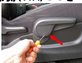
22、矢印の箇所からカバーを外します。
