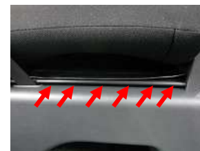
4、引っ掛けた後、強く押さえ外れない事を確認して下さい。
