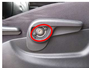
23、中のネジを2本とも緩めレバーを外します。
