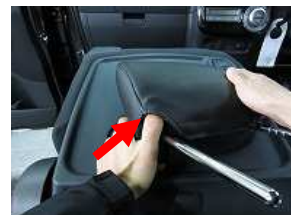
4、カバーの隙間より指を入れ生地を直します。
