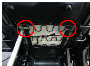
7、前からバンドを回し、赤丸部に通しマジックテープで固定します。
