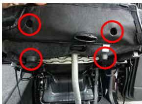
5、シートのストッパーとカバーの穴を合わせます。
