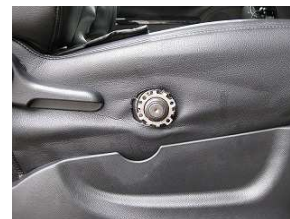
24、画像のように、カバーを被せシートリフターの土台を逃す穴を開けます。
