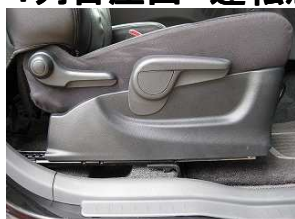
21、シートリフターが装備されている場合は取り外し、加工を行います。
