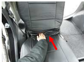
3、背もたれとの間にカバーを入れ込み後ろから引き出します。
