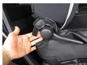
11、リクライニングレバー部は、レバーを逃してカバーを被せマジックテープで固定します。
