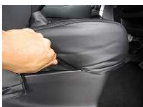
10、ヘラを使って、側面のプラスチック部の中に生地を入れ込みます。
