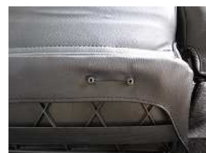
8、カバーの切れ込みとネジ穴の位置を合わせます。
