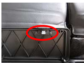
6、赤丸部のロック部を、プラスドライバーで取り外します。
