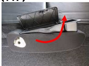
2、矢印の方向に小物入れを取り外します。
