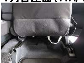
1、始めに座面後ろのシート下に巻き込んでいる生地を外します。シート下にゴムバンドで固定してあります。
