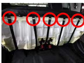
6、5で引き出したゴムバンドを画像の様に、赤丸部に固定します。(5箇所)
