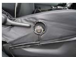
11、シートリフター有り車は画像のようにカバーの切れ込みで土台を逃します。
