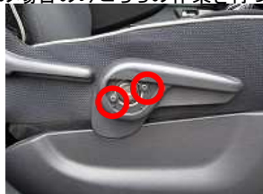
2、中にあるネジをプラスドライバーで取り外します。(2箇所)レバーを取り外します。
