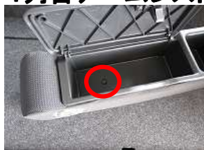
1、赤丸部のネジをプラスドライバーで取り外します。
