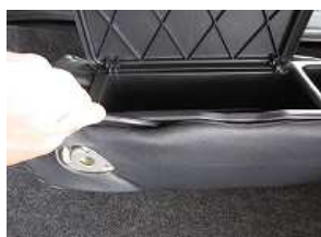
5、小物入れを元に戻し、プラスチックの部分にカバーを入れ込みます。
