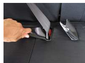
8、シートベルトをバックルに差し込み、ベルトを持ちながら、バックル部のカバーを折り返し入れ込みます。
