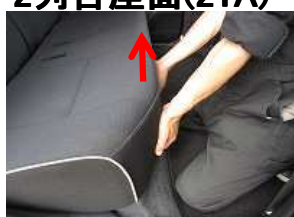
1、座面の手前側を持ち上げロックを解除します。
