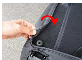
7、シートを裏返し、カバーのマジックテープを直接シートに貼り付け固定します。
