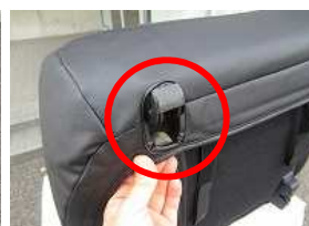
4、シートの台座をカバーの穴で逃がします。
