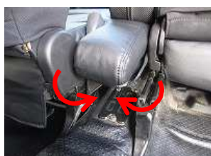
13、運転席側と同様に取り付け、アームレスト下部のカバーはマジックテープを貼り合わせ固定します。
