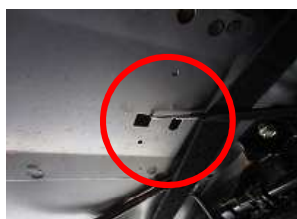
9、取り付けしたS字フックはシート下の金属部に引っ掛け固定します。
