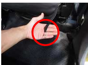
10、4で引き出したカバーの先端のバンドにも同様にS字フックを取り付け、シート下の金属部に引っ掛け固定します。
