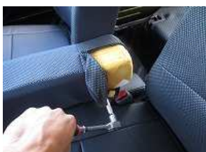
2、純正生地をめくり、ソケットレンチを使用しボルトを緩め、アームレストを取り外します。
