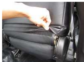
7、6で引き出したカバーのマジックテープと背面のマジックテープを貼り合わせ固定します。
