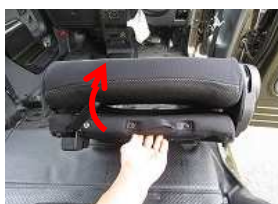
2、座面の取っ手を持ち、シートを前方に跳ね上げ、車両より取り外します。
