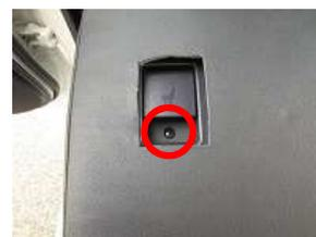
12、助手席側の裏面には、シートのスライドレバーが装備されています。丸部のネジをプラスドライバーで緩めます。
