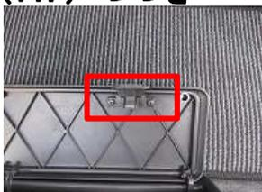
6、小物入れのフタのロック部のネジをプラスドライバーを使用し外します。
