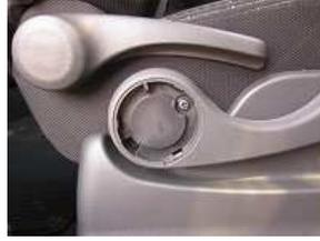
3、中のネジをプラスドライバーで緩め外し、シートリフターのレバーを取り外します。
