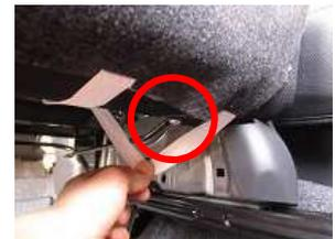
20、1で外したバンドの内側にトレイのレールが通っています。丸部のネジを緩め外し、バンドを取り外して下さい。
