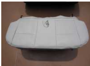
3、車外に取り出し、シート全体にカバーを被せます。
