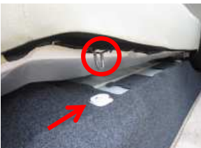
2、赤丸部の金属部が車両の矢印部に固定されています。
