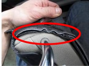
3、背もたれより取り外し、縫いしろ(赤丸部)を引っ張り出しラインを合わせシャフト部のマジックテープを固定します。
