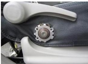
5、シートリフター無し車の説明を参照し、カバーを取り付け、カバーの穴からシートリフターの台座部を取り出します。
