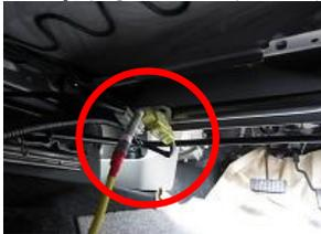
1、車輛のバッテリーのマイナス端子を外し、5分ほど時間をおき、丸部の黄色のカプラーを外します。
