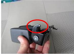
10、車両に戻す際は、赤丸部のツメを座面に引っ掛け戻します。
