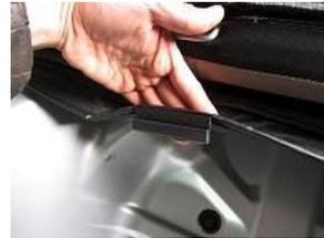
8、カバーの先端に付いているフックをシートに固定します。
