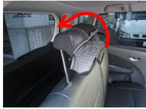
7、後席ヘッドレスト有り車はカバーを裏返し矢印の方向に被せ、後は前席と同様に被せます。
