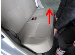
2、座面の手前を持ち上げ固定しているピンを外します。
