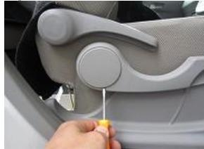
3、シートリフターのカバーを先の細いマイナスドライバーで外します。
