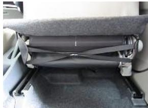
11、カバーに付いている左右のバンドを、シート背面にて付属のS字フックを使用し固定します。
