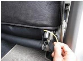
9、サイドエアバッグ装備車の場合上記と同様に取り付け、カバーの隙間より座面の取り付け作業の際に取り外した配線を取り出して下さい。
