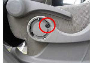
4、中のネジをプラスドライバーで緩めシートリフターを取り外します。
