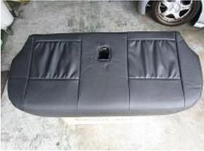
9、シートベルトのバックル部のカバーを折り返し完成です。背もたれの作業が終わってから元に戻します。
