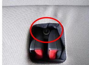
1、はじめにシートベルトのバックル奥にあるボルトを緩めます。(ボルトサイズ14mm)
