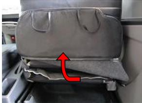
5、座面で取り外した純正の生地をカバーの中に入れ込みます。
