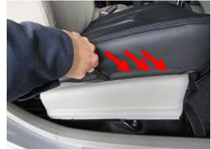
8、側面のカバーを付属のヘラ等を使用しプラスチックの中に入れ込みます。
