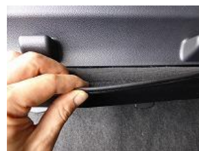
4、3で引き出したカバーの先端のマジックテープを直接シートに張り付け固定します。
