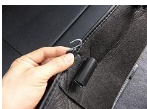
1、カバー裏側に付いているゴムすべてにS字フックを取付ます。
