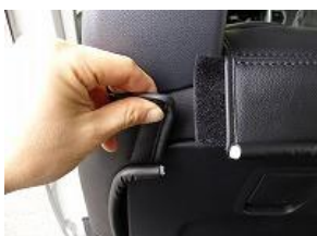
6、肩口裏側のマジックテープを張り付け固定します。
