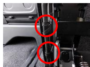
8、7と同じ箇所に付いているS字フックを赤丸部分でシート本体に引っ掛け固定します。手が入りにくい場合はシートをスライドさせてください。
