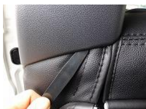
7、肩口のシートベルト部分にヘラを使い生地を入れ込みます。
