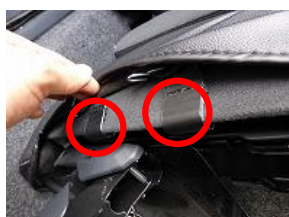
7、内側側面のブラフックを赤丸部分に引っ掛け固定します。
