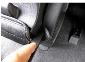
5、3で引き出したカバーの両サイドの生地をヘラで隙間に差し込みます。
