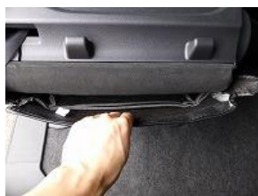
3、2で入れ込んだカバーを後ろから引き出します。
