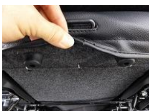
6、シートを跳ね上げ、5で引き出したカバーの先端のマジックテープをシートに直接張り付け固定します。
