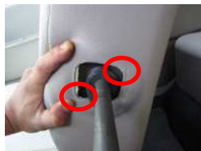
3、赤丸部のネジを緩め台座を取り外します。
