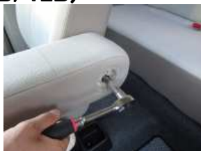
2、ソケットレンチを使用し、中のネジを外し、レバーを取り外します。 (ボルトサイズ12mm)
