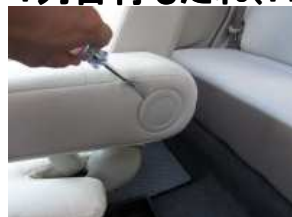
1、アームレストを取り外します。 側面のカバーをマイナスドライバー等 で外します。
