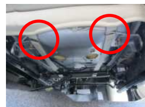
12、赤丸部の部分に11で後ろに回したバンドを通し、マジックテープで固定します。 ※バンドを引っ張り過ぎると切れま すので注意して下さい。
