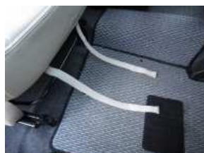
11、カバー前方のバンドをシート下を通して後ろに回し固定します。
