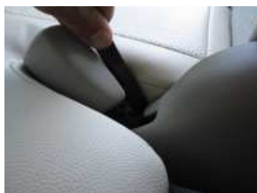
6、付属のヘラを使用して、シートベルトバックル部周りのカバーを入れ込みます。
