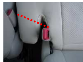
8、内側側面の紐は座席下の点線の箇所を通します。
