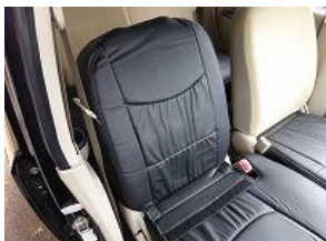
6、表に返しながらシートとカバーのラインを合わせ左右均等に下ろします。
