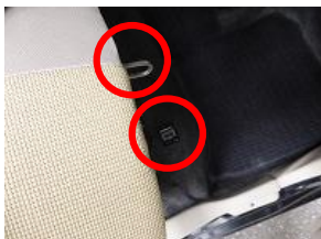
2、赤丸の部分同士がはまっているだけなので引っ張るだけで簡単に取り外せます。
