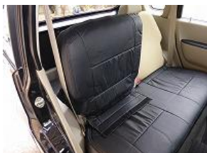
2、表に返ししながらシートとカバーのラインを合わせ左右均等に下ろします。
