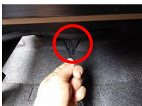
15、助手席側の紐は後方の輪っか部分に通してから結んで固定します。
