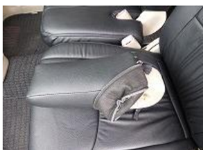
2、表に返しながらアームレストとカバーのラインを合わせ、画像の状態まで被せます。
