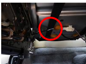
13、12でシート裏に出したゴムにS字フックを取り付け引っ掛けて固定します。
