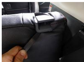
11、リクライニングレバー付近の生地をヘラで差し込みます。
