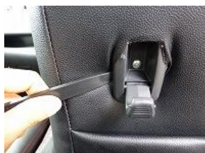
15、コンビニフック付近の生地をヘラを使い、シートとの隙間に差し込みます。
