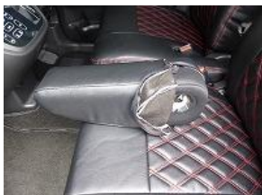
2、表に返ししながらアームレストとカバーのラインを合わせ、画像の状態まで被せます。
