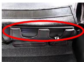
7、6で取り外した純正のブラフックに4で引き出したカバーのブラフックを引っ掛け固定します。
