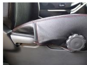
20、入れ込んだ画像です。※シートリフターを上下させると生地が出て来てしまいます。高さを固定してから19の作業を行ってください。
