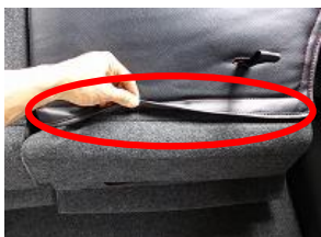
10、赤丸部のマジックテープを純正生地に直接張り付け固定します。
