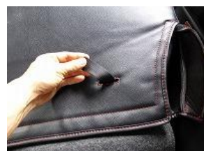
8、純正のバンドをカバーの穴より取り出します。
