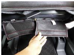
6、5で入れ込んだカバーを後ろから引き出します。
