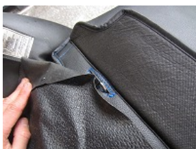
13 2で外した純正生地を取り付けます。
