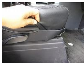
15、両サイドの生地をヘラを使い、プラスチックカバーの中へ入れ込みます。
