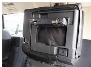
7、裏側のマジックテープをシート本体に張り付けて固定します。
