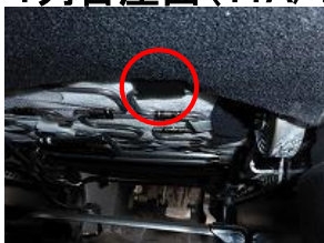
1、シート裏側に引っ掛けてある純正のフックを外します。
