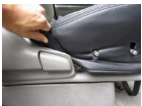
10、側面のカバーを付属のヘラ等を使用しプラスチックの中に入れ込みます。
