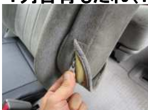
1、純正のアームレストの生地をめくりチャックを開けます。 ※1-3はアームレストの有る車のための作業です。
