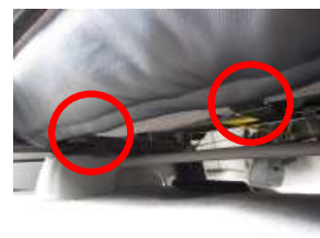
12、11で後ろに回したバンドを、赤丸部の金具を通し、マジックテープで固定します。
