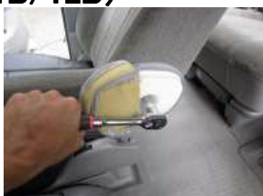
2、ソケットレンチを使用してアームレストを取り外します。 (ボルトサイズ14mm)
