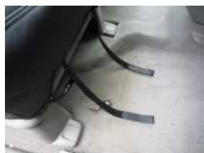
11、カバー前方のマジックテープバンドをシート下を通し後ろに回します。 ※シート下を通す際は、シートの可動の妨げにならない箇所を通して下さい。
